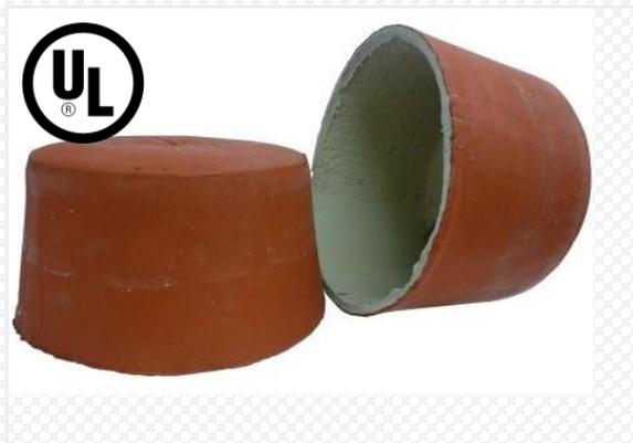
La cloche FF109X de FSS est la seule barrière anti-incendie ayant deux heures de résistance au feu selon UL et pouvant être utilisée avec une large gamme d'éclairages encastrés afin de prévenir efficacement la progression du feu via une ouverture du plafond.
