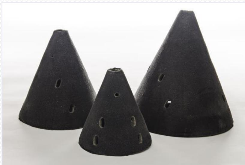
**FSS** et ses cloches de protection pour spots FF109 sont des cloches de protection des spots résistantes au feu et au son ou des capots anti-incendie conçus pour la résistance au feu des fixations des plafonniers et pour restaurer les performances des plafonds lorsque ceux-ci ont été percés pour y encastrer des plafonniers. Ces cloches existent en différentes tailles pour convenir à une grande variété de produits d'éclairage, en plus de ceux couverts par des plafonniers à résistance au feu.
